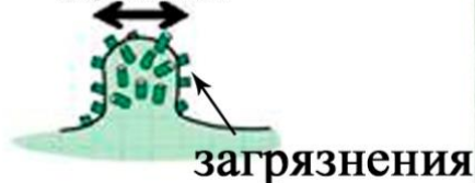
Рисунок 20 – Схема формирования капли воды на гидрофобной поверхности и способность самоочищаться этой поверхностью.
