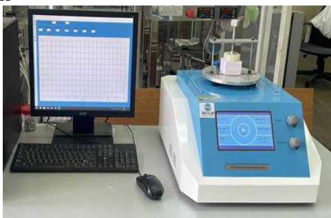
Рисунок 3 – Внешний вид установки по измерению коэффициентов теплопроводности
