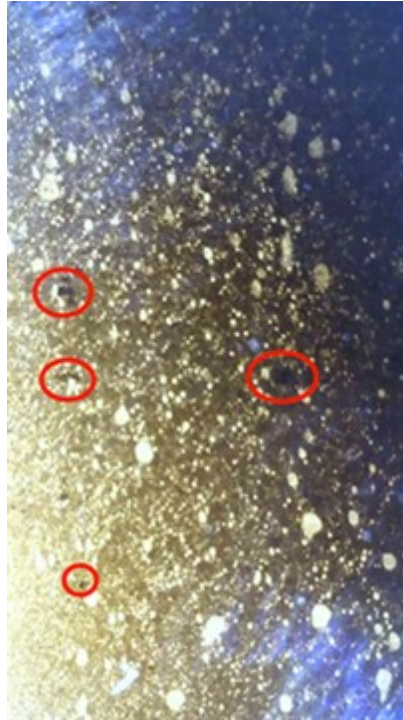
Рисунок 4.27 – Микроизображение шлама (рисунок 4.24, а). Красным обозначены черные включения
