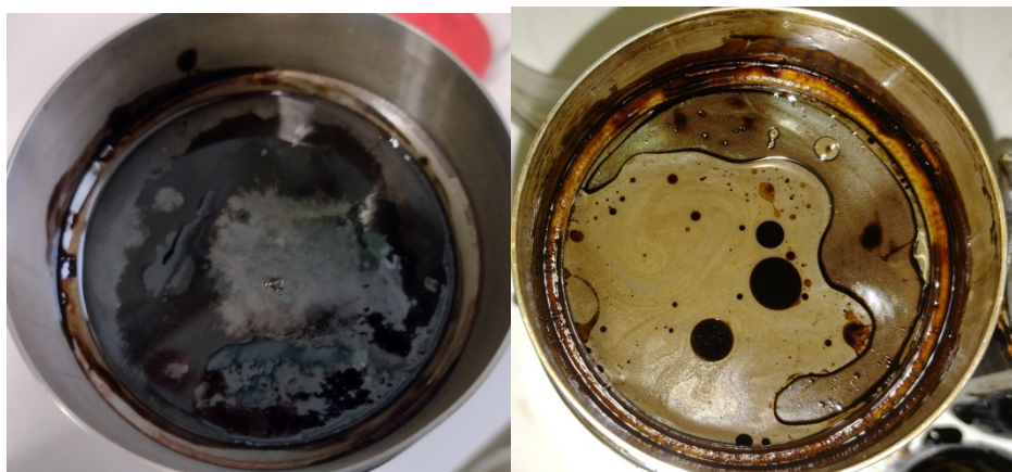
Рисунок 4.26 – Вид сита при смешении нефти с хелатной композицией: (а) 1:1, без ПАВ, 80°С, (б) 1:1, с ПАВ, 25°С
