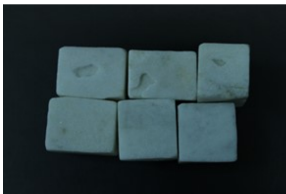
Рисунок 4.24 – Образование структур растворения на поверхности гидрофобных образцов мрамора при обработке хелатной композицией без ПАВ
