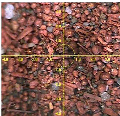
Рисунок 24 - Металлическая медь, полученная после выщелачивания
