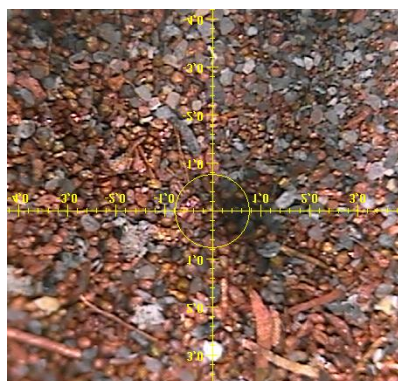
Рисунок 35 - Металлическая медь, полученная после выщелачивания шлака бронзы серной кислотой без перекиси водорода (Бронза -211)
