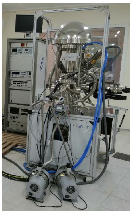
Рис. 5.4 – Рентгеновский электронный спектрометр SPECS с полусферическим электростатическим энергоанализатором Phoibos-150.
