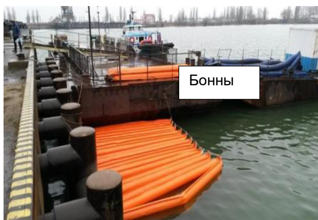
Рисунок 5.2 – Бонны, наполненные сорбционным материалом Гринсорб Х
