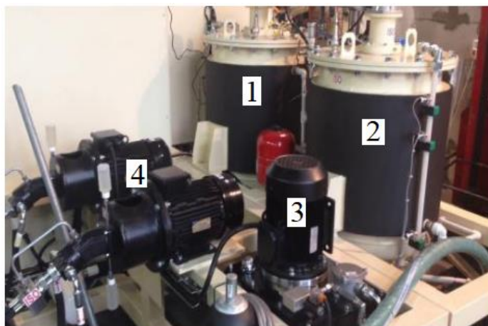
Рисунок 5.5 – Оборудование для получения Гринсорб Х: 1 – емкость с компонентом А + хитозан, 2 – емкость с компонентом Б, 3 – смеситель, 4 – дозирующие насосы, 5 – гибкий трубопровод
