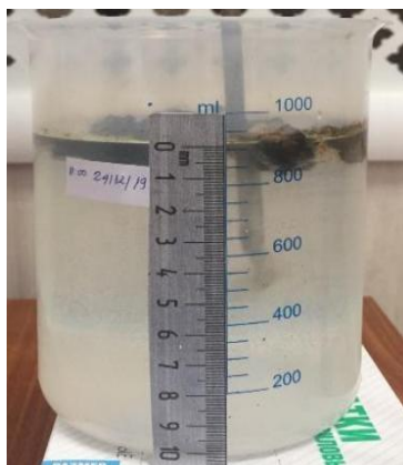
Рисунок 3.18 – Плавучесть сорбционного материала в динамических условиях для среды нефть-вода. Время экспозиции 1 час
