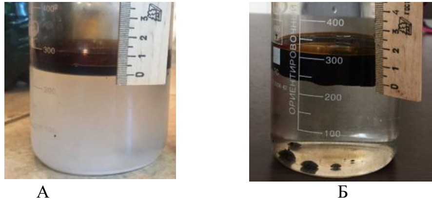
Рисунок 3.19 – Модель нефтяного разлива в зависимости от количества разлитой нефти: 20 : 250 (г/г) нефть : вода (а), 50 : 250 (г/г) нефть:вода (б)
